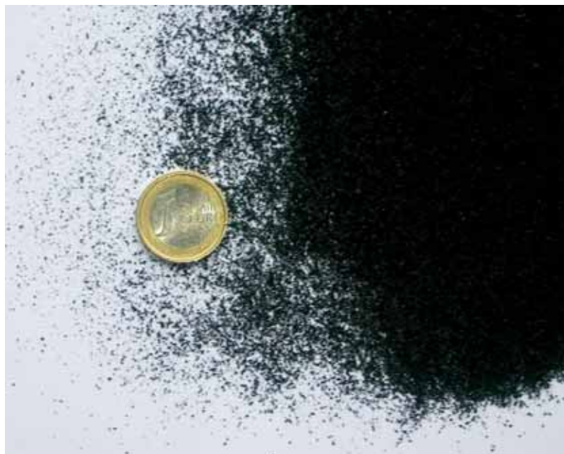
Il "polverino", costituito dalla parte elastometrica degli pneumatici fuori uso sottoposta a trattamenti di separazione e riduzione dimensionale
