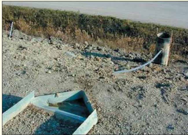
Figura 4.10: dispositivo di raccolta delle acque di run-off
