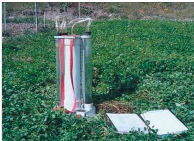
**Figura 5.1** Prova di conducibilità idraulica con permeametro Amoozometer
