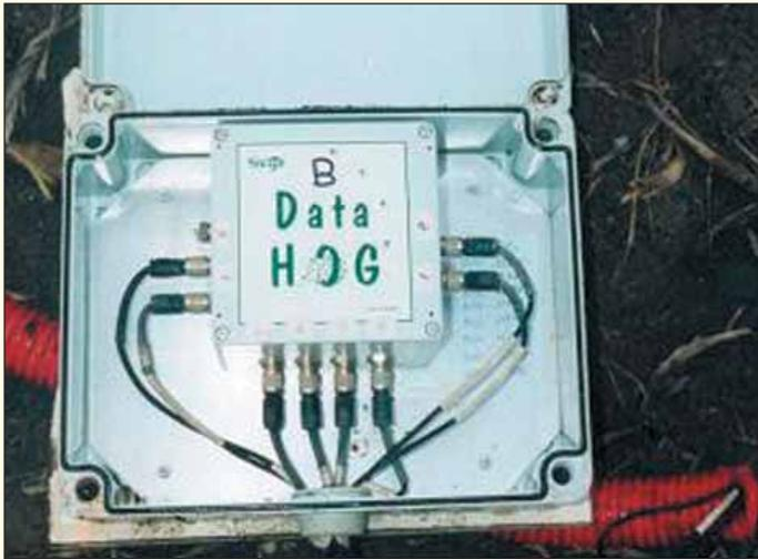
Figura 4.5: Acquisitore dati automatico per tensiometri
