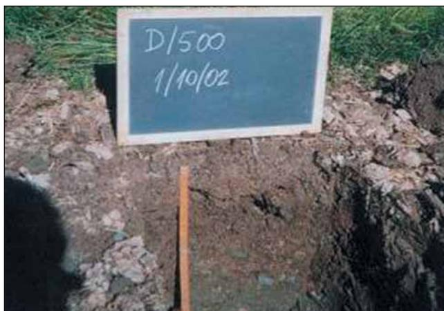
**Figura 5.2:** Profilo pedologico (minipit) aperto per la caratterizzazione dei suoli a fine periodo di monitoraggio
