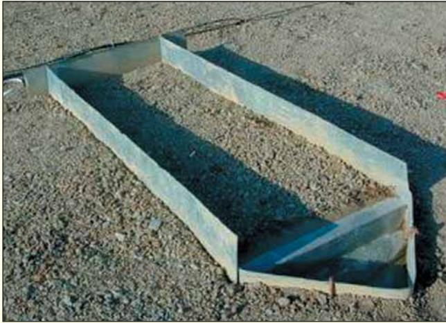
Figura 4.9: Dispositivo per la cattura delle acque di run-off
