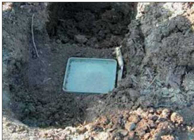
**Figura 5.3:** Determinazione della densità apparente con metodo per escavazione
